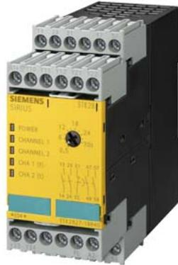
!!! Producto a extinguir El sucesor preferente es 3SK1121-1CB42 Módulo de seguridad SIRIUS con circuitos de habilitación de relé (FK) DC 24 V, 45 mm borne de tornillo FK instantáneo: 2 NA FK retardado: 2 NA, 0,5...30 s MK: 1 NC arranque vigilado aparato base máximo alcanzado SIL: 3/2, PL: e/d
