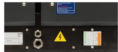
2. Smontare le sei viti di fissaggio della piastra d'ingresso d'alimentazione e del magnetotermico. Passare il cavo di segnale ( $\varnothing 4 - 8\text{ mm}$ ) nell'isolatore passanti Pg9 e fissarlo al supporto interno, verificando che il cavo giunga fino al connettore della scheda di controllo alla quale sarà collegato.
