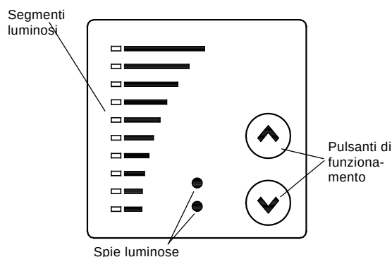
Fig. 40 Pannello di controllo di una pompa NBE, NKE
